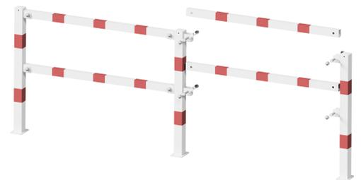
5. Zur Positionierung des nächsten Pfostens, die Querholme in die Laschen des bereits positionierten Pfostens und in den danach zu setzenden Pfosten einlegen. siehe Abb. 2
