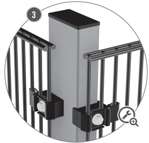
Ansicht fertige Montage untere Gitteraufnahmen
