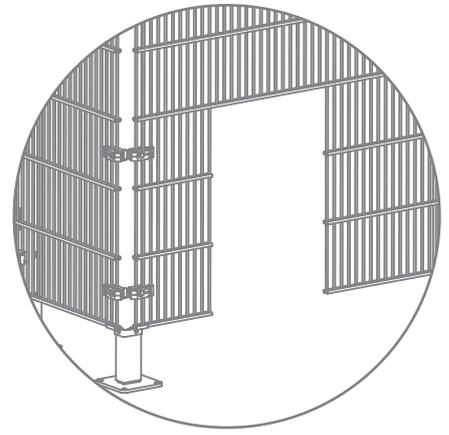
Durch die Größe und die Position der Öffnungen darf die Stabilität des Gitterelements nicht beeinträchtigt werden.
